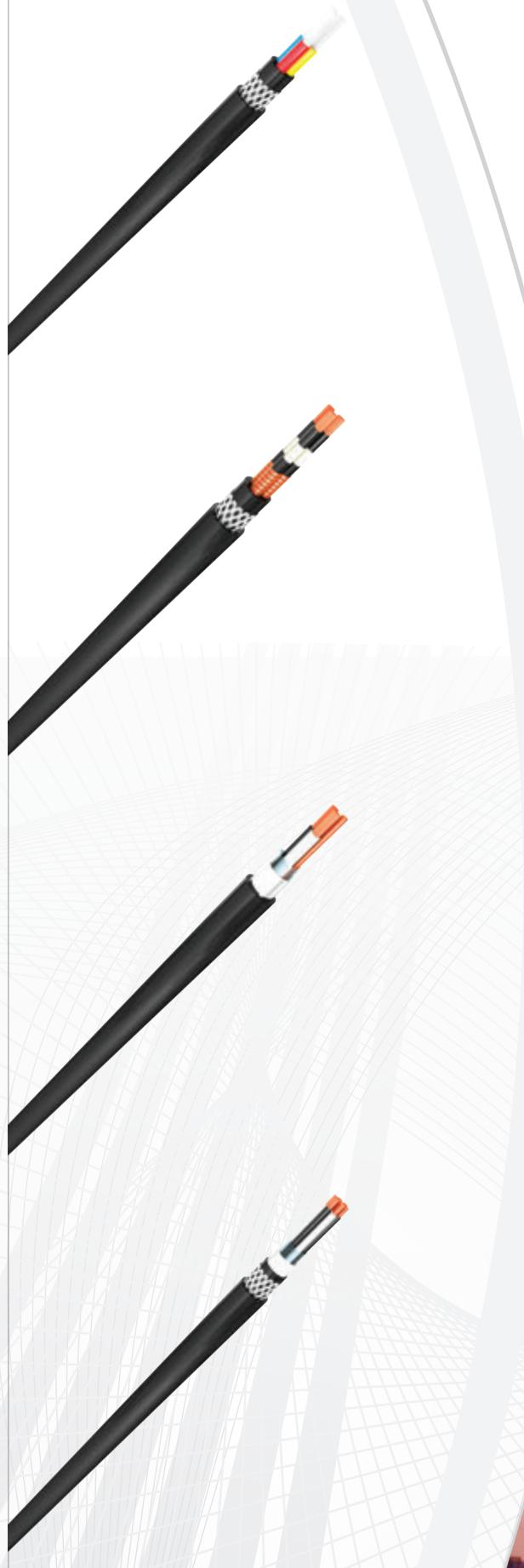
Svi brodski kablovi iz našeg programa su bezhalogeni, ne emituju plamen ni štetne gasove prilikom gorenja. Napravljeni su u skladu sa vodećim svetskim standardima IEC60 331 – test otpornosti na gorenje, IEC 60 332 – test širenja plamena, IEC 61034 – test gustine dima, IEC 60754 – test emisije gasova.
